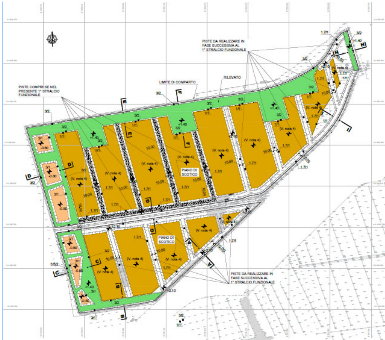
Figura 13 – Area Logistica S3 Nord – Planimetria di progetto con piste
