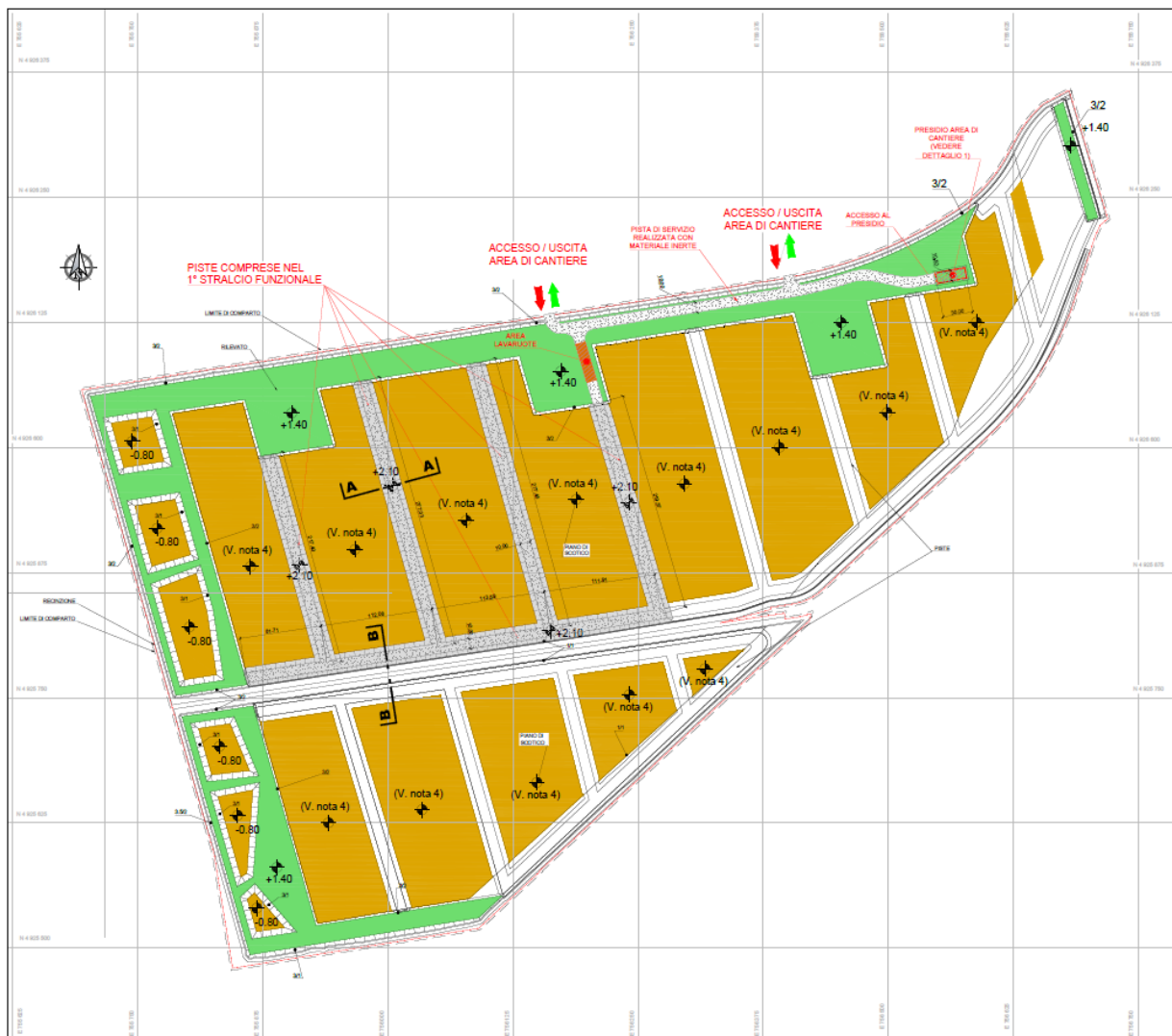
Figura 14 – Comparto S3 Nord -- Stralcio planimetrico della predisposizione dell'areale a terra prima del riempimento con materiale di dragaggio
