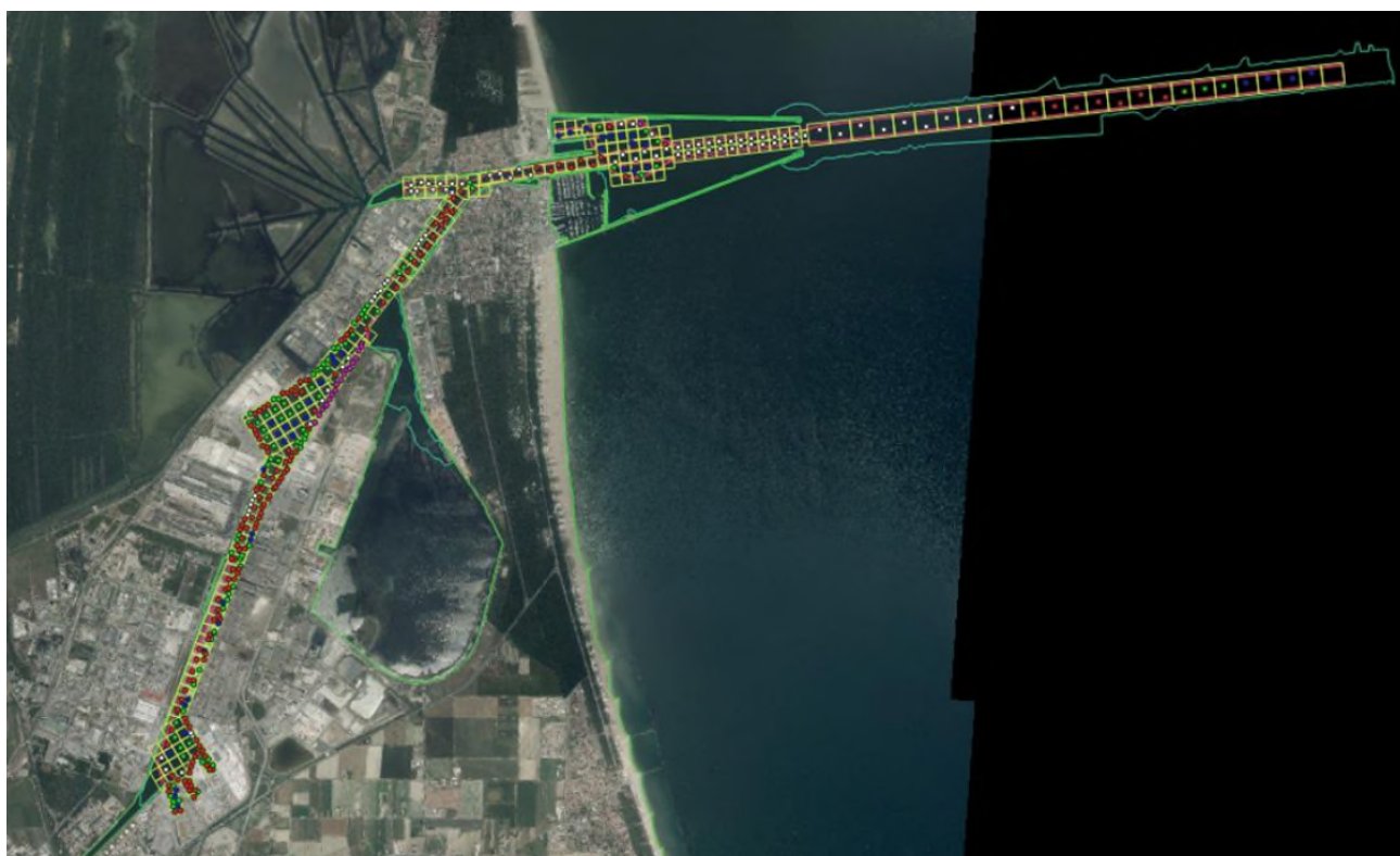
Figura 3 – Descrizione indagini geotecniche – Aree di dragaggio – Indagine 2019 – Planimetria di ubicazione dei n. 402 sondaggi da doc. rif. [24]
