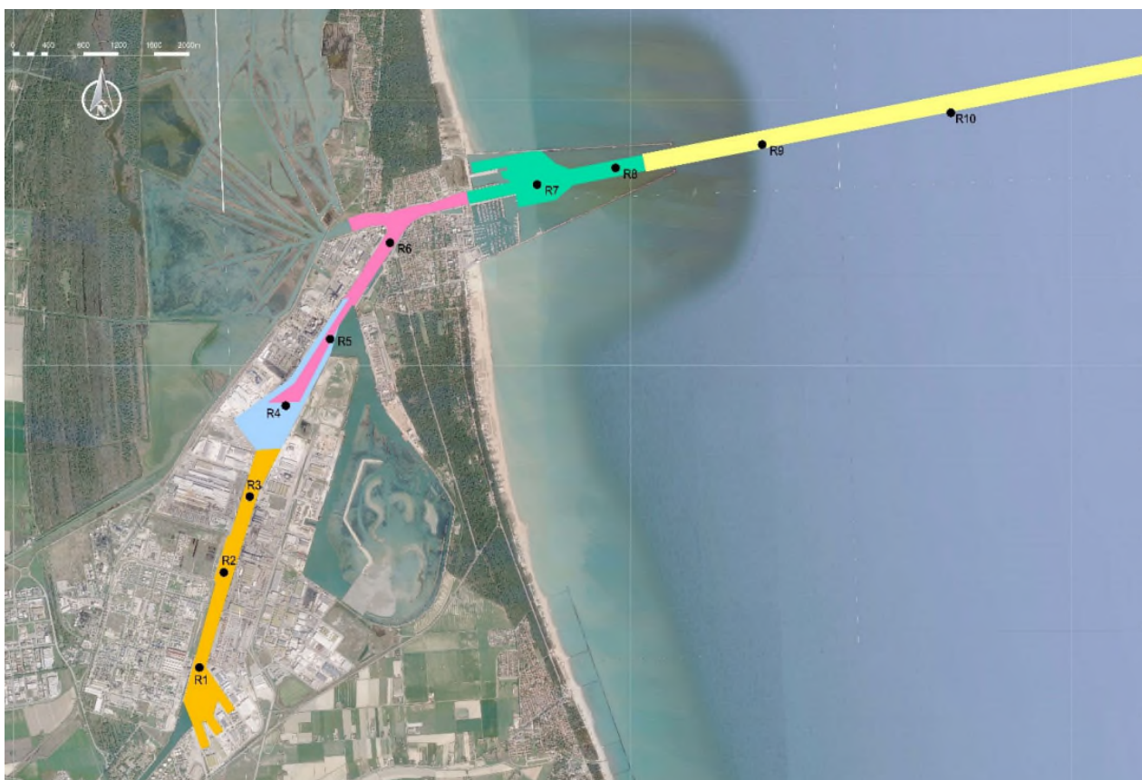
Figura 4 – Descrizione indagini geotecniche – Aree di dragaggio – Indagine 2020/2021 – Planimetria di ubicazione dei n. 10 sondaggi da doc. rif. [22]
