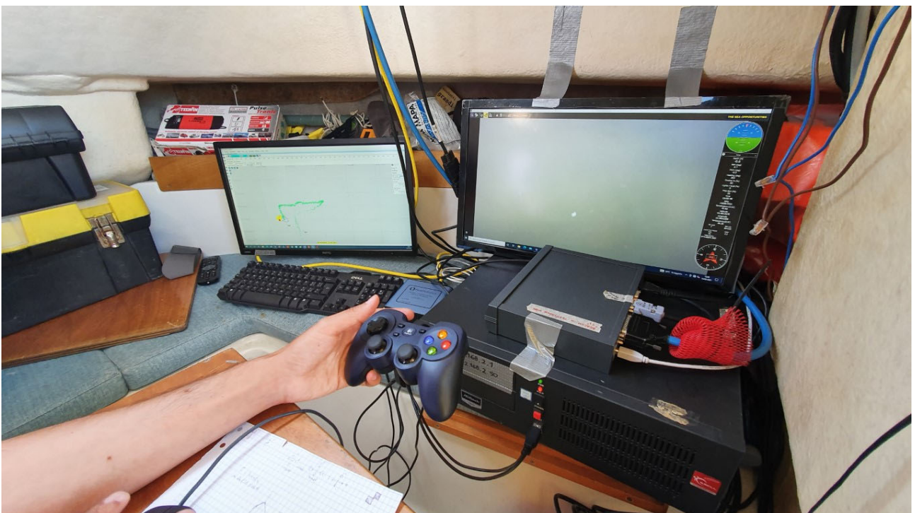
Figura 8: sistema di controllo e pilotaggio del ROV
