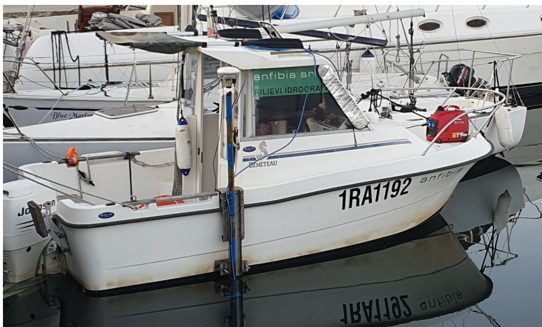
Figura 5: la M/B Anfibia con installato il sistema di posizionamento (GNSS9 e tracciamento subacqueo (USBL)
