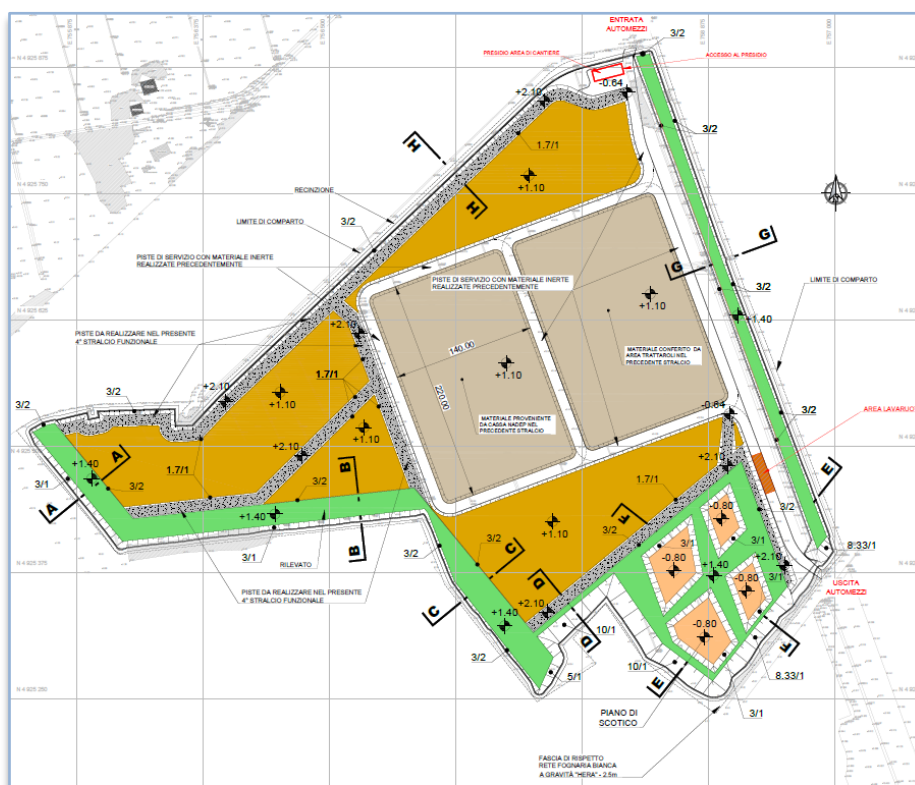
Figura 18 – Area Logistica S3 Sud: configurazione di progetto. In marrone le aree di deposito dei materiali provenienti dalle casse di colmata Nadep e Trattaroli
