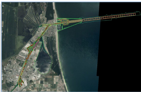
Figura 4 – Canale Candiano e Baiona – Piano di caratterizzazione ai sensi del D.M. 173/2016
