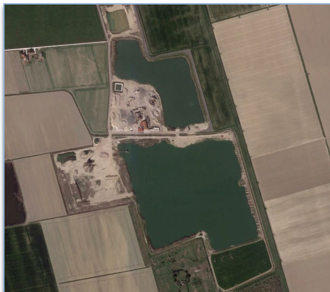
Figura 2 – Cava “La Bosca” – Inquadramento dell’area oggetto di ripristino ambientale attraverso il riempimento dei due specchi acquei “generati” dall’attività estrattiva dismessa in falda salina per la presenza del cuneo salino
