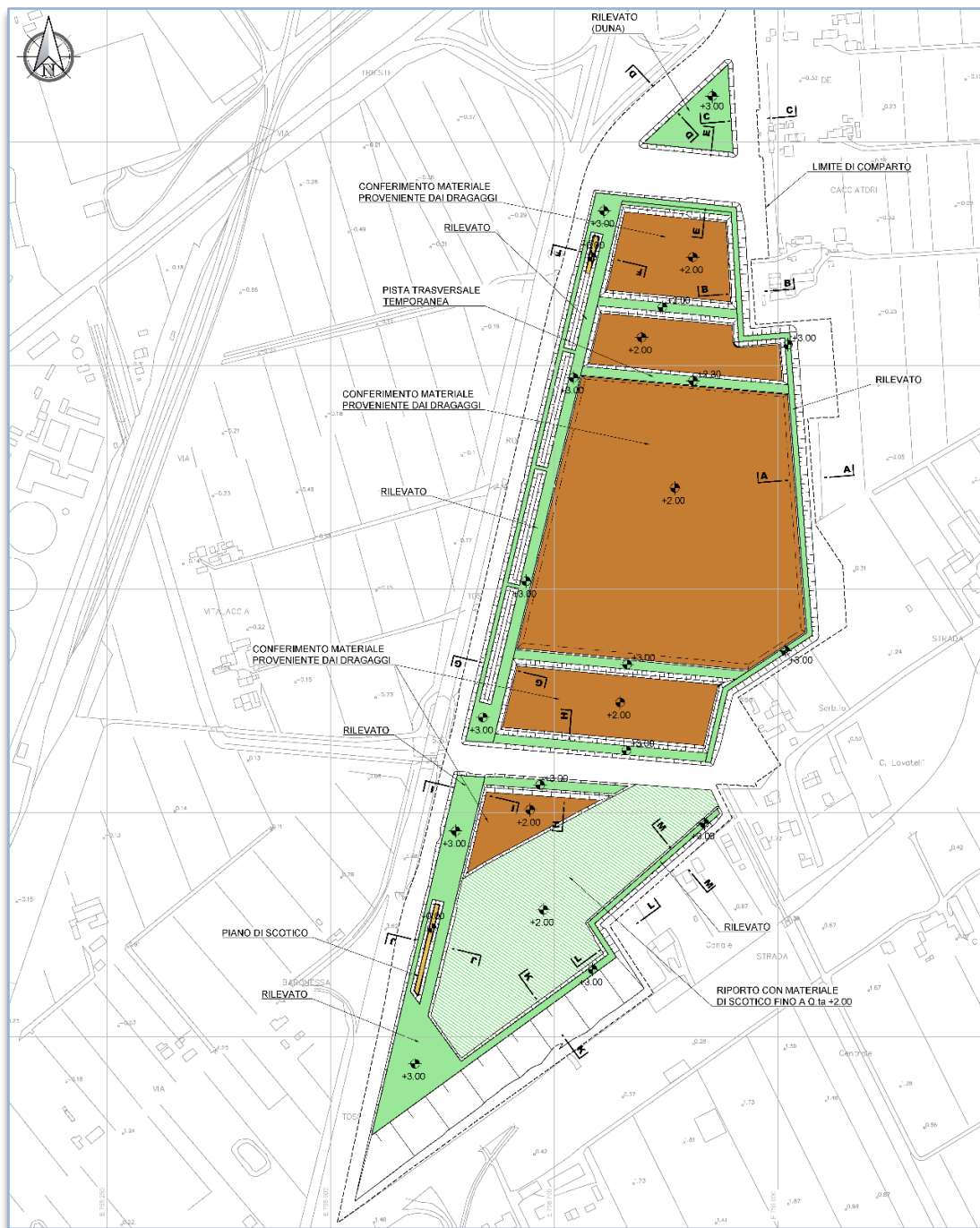
Figura 19 – Area Logistica L2: configurazione di progetto. In marrone le aree di deposito dei materiali provenienti dai dragaggi
