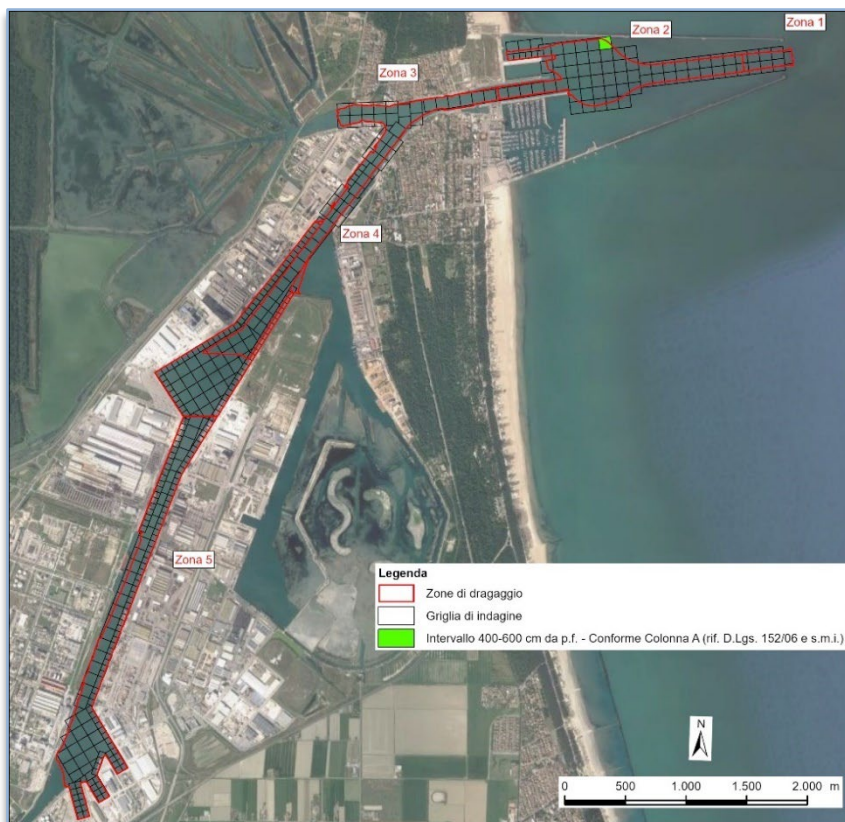
Figura 42 – Risultati della caratterizzazione ambientale dei sedimenti da dragare. Intervallo 400-600 cm
