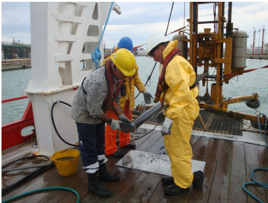
Figura 4 – Operazioni di apertura carotiere ed estrazione liner
