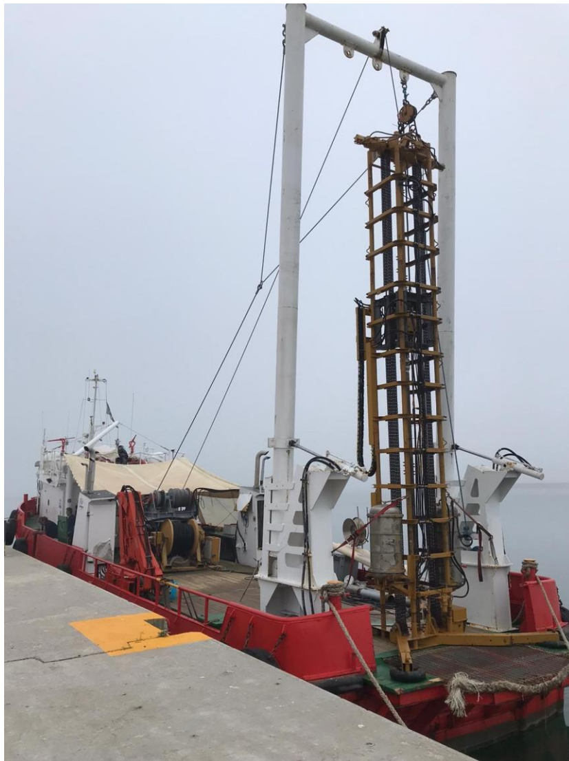
Figura 2: Imbarcazione "Grecale primo" attrezzato con carotiere SHSBD-A
