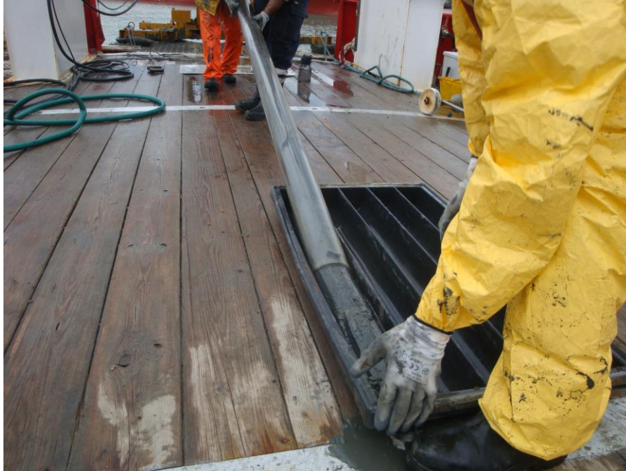
Figura 5 – Posizionamento carota in cassetta catalogatrice
