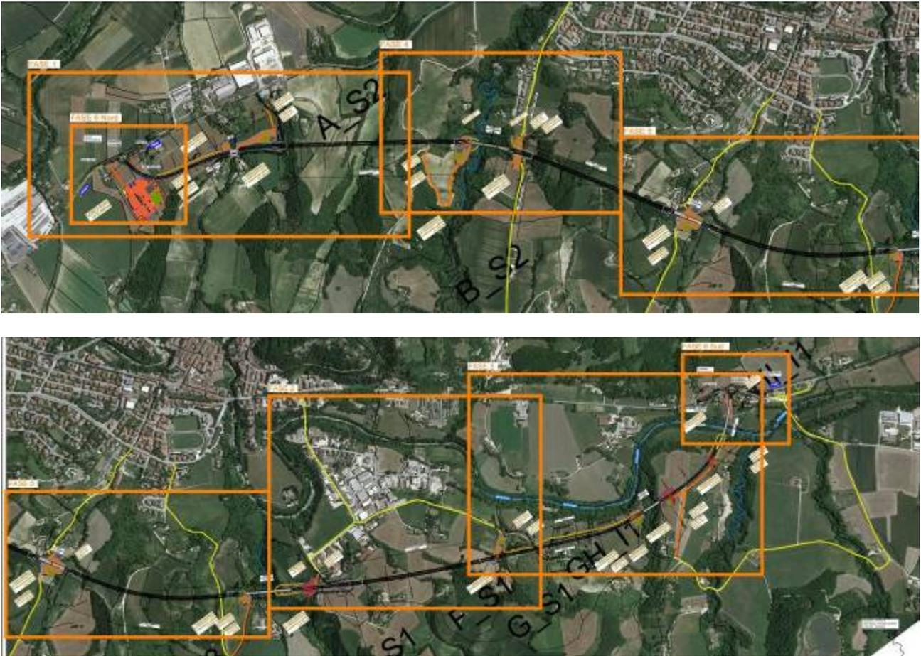
Fig. 2.a e b Planimetria generale su ortofoto con individuazione del Campo Base, dei Campi Operativi e delle viabilità di accesso.
