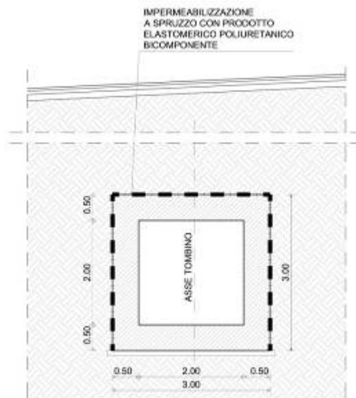
Tutti i tombini sono caratterizzati dall'aver un pozzetto di imbocco in cemento armato gettato in opera, nel quale confluiscono i gabbioni a monte, di dimensioni interne 2.00 m. x 3.00 m. e spessore delle pareti pari a 40 cm., mentre l'altezza del pozzetto varia da tombino a tombino.
