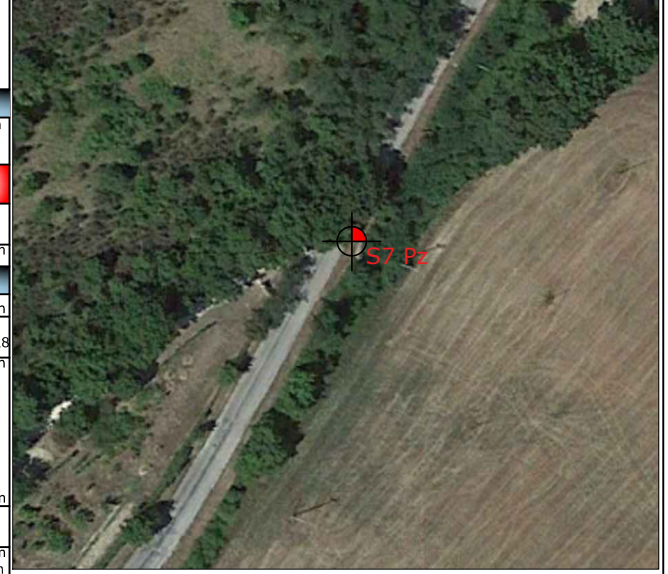
Ubicazione del sondaggio S7 Pz Sondaggio geognostico spinto fino a m 20.00 da p.c.
