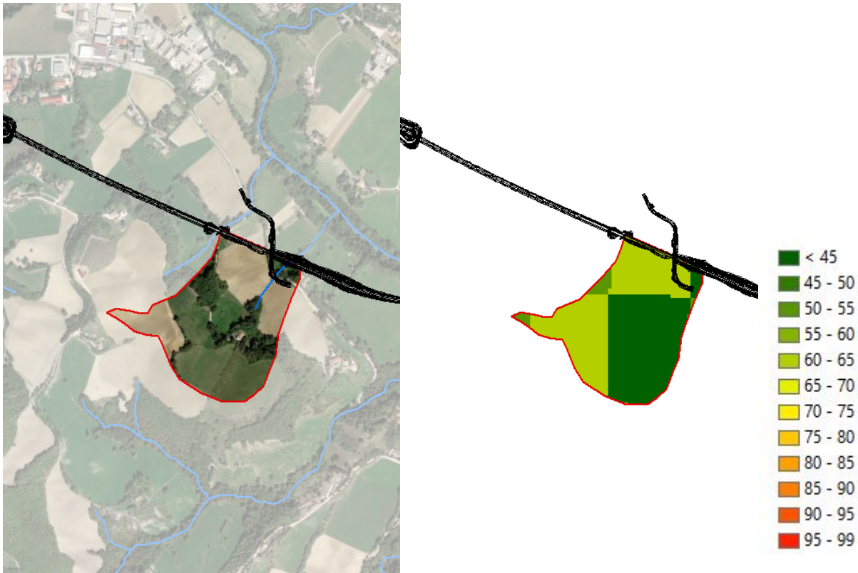
A sinistra: vista planimetrica del bacino in esame, con indicazione del tracciato stradale di progetto. A destra: andamento spaziale del parametro CN-II nell'area di interesse
