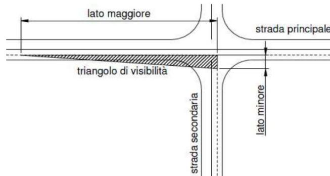
In particolare, il lato maggiore del triangolo di visibilità viene rappresentato dalla distanza di visibilità principale D, data dall'espressione:
