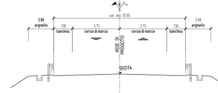
ASSE PRINCIPALE - SCHEMA SEZIONE TIPO ALLARGAMENTI IN CURVA
