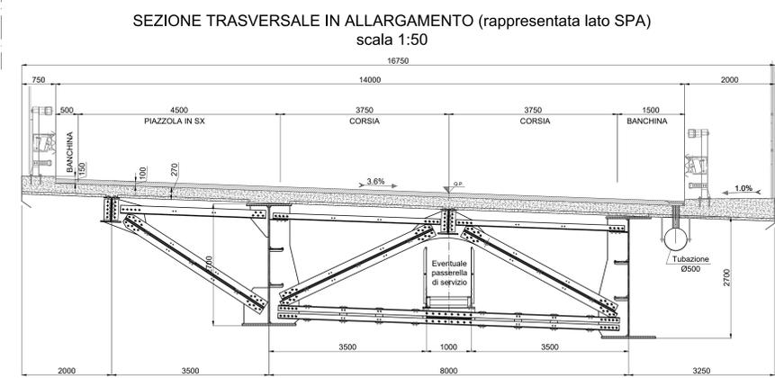
LE DIMENSIONI INDICATE NELLE PIANTE E SEZIONI SONO IN ASSE TRACCIATO E NON TENGONO CONTO DELL'EFFETTO DATO DALLA LIVELLETTA LONGITUDINALE (ricavata da progetto stradale in ultima revisione) E DELLA CONTROMONTA. TUTTI QUESTI ELEMENTI DOVRANNO ESSERE COMPIUTAMENTE SVILUPPATI E VERIFICATI NELL'AMBITO DELLA STESURA DEI DISEGNI COSTRUTTIVI DI OFFICINA.
