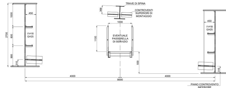
PIANTA CONTROVENTI SUPERIORI DI MONTAGGIO scala 1:40
