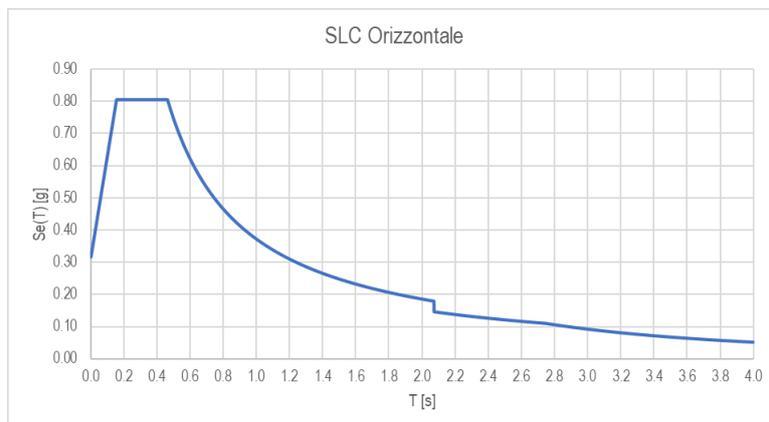
**Figura 4.33 Spettro di risposta orizzontale SLC con smorzamento equivalente del 10%.**
