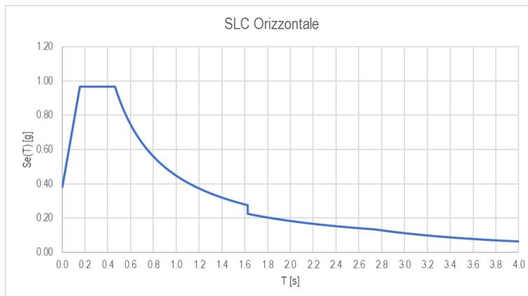
**Figura 4.22 Spettro di risposta orizzontale SLC con smorzamento equivalente del 10%.**
