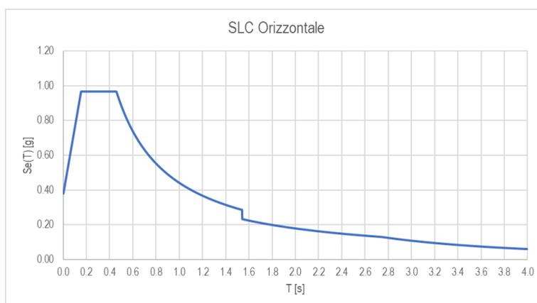
**Figura 4.22 Spettro di risposta orizzontale SLC con smorzamento equivalente del 10%.**
