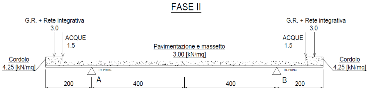
Figura 4.4 reazioni per carichi permanenti strutturali – Sezione tipica
