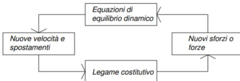
Figura 8.1: Fasi di computazione del codice di calcolo FLAC
