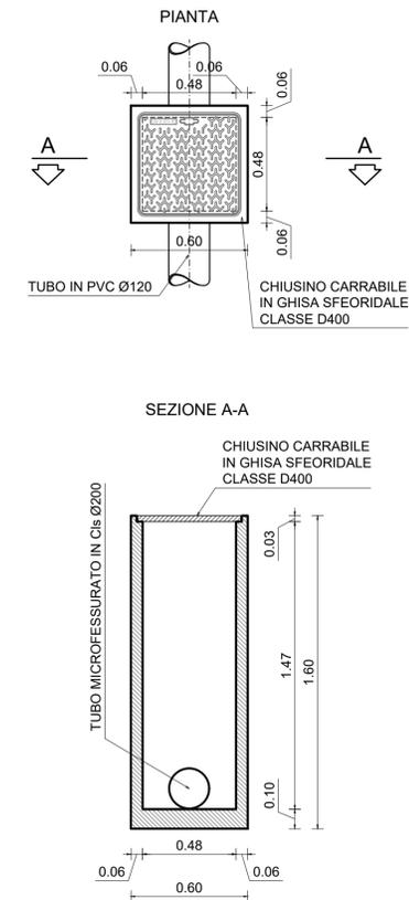
**POZZETTO RACCOLTA ACQUE DI DRENAGGIO**
