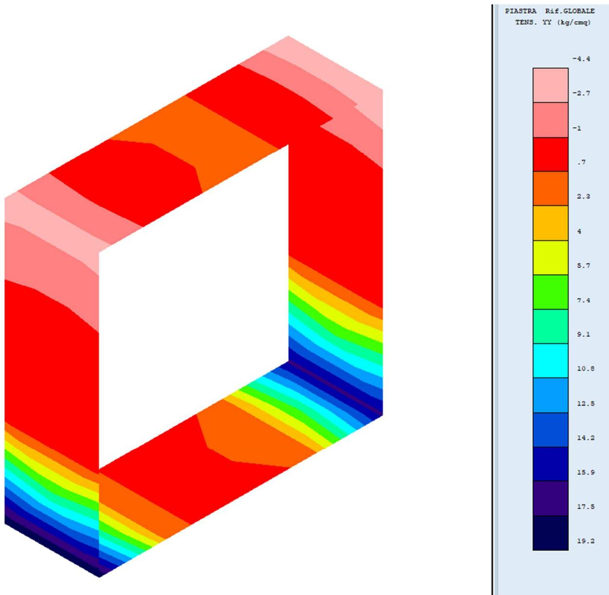
Figura 8: Tensore yy – SLV comb. 8
