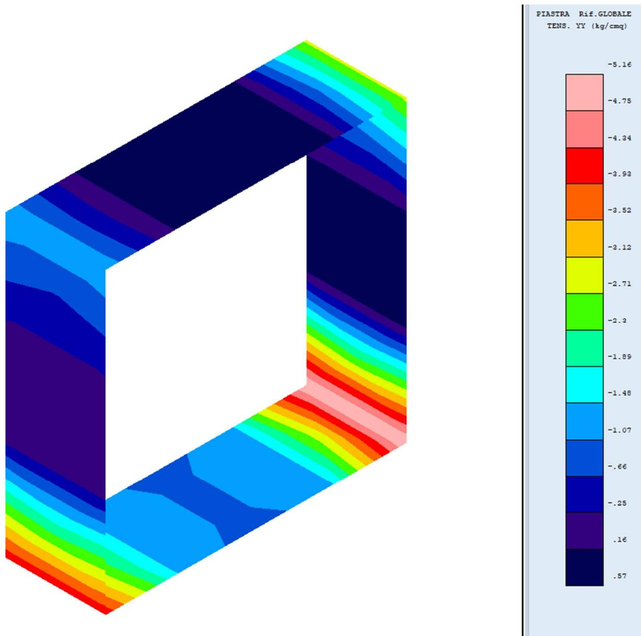
Figura 10: Tensore yy – SLE freq. comb. 1
