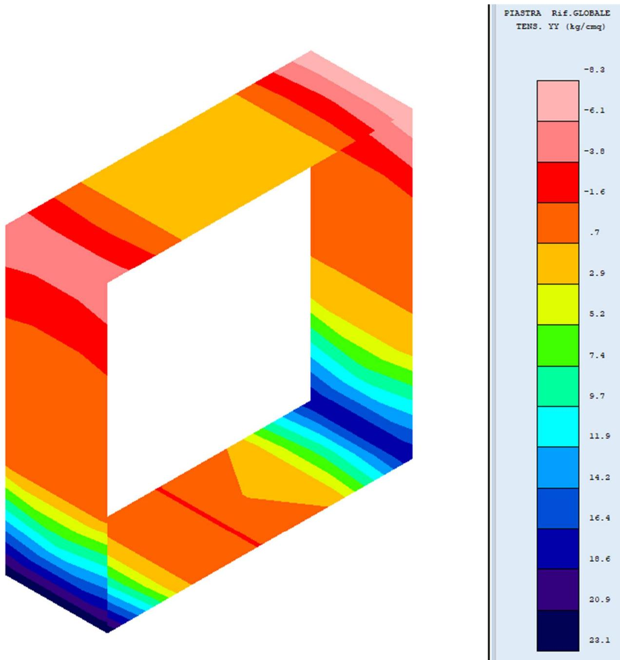
Figura 8: Tensore yy – SLV comb. 8
