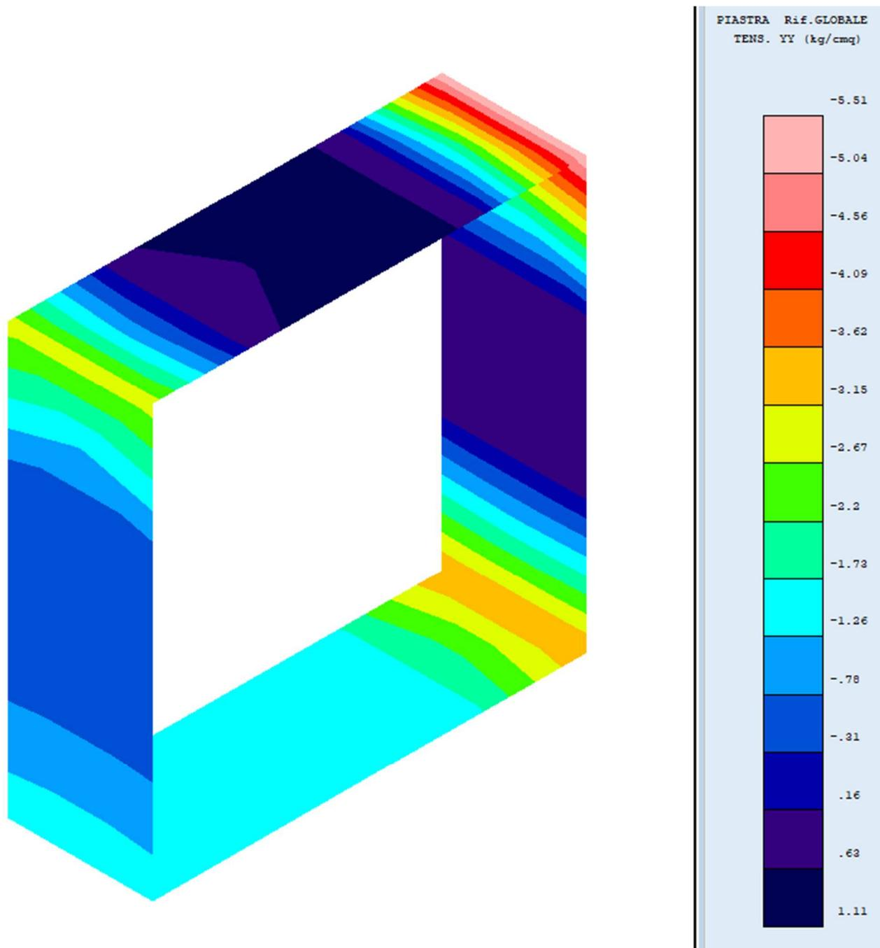
Figura 10: Tensore yy – SLE freq. comb. 1
