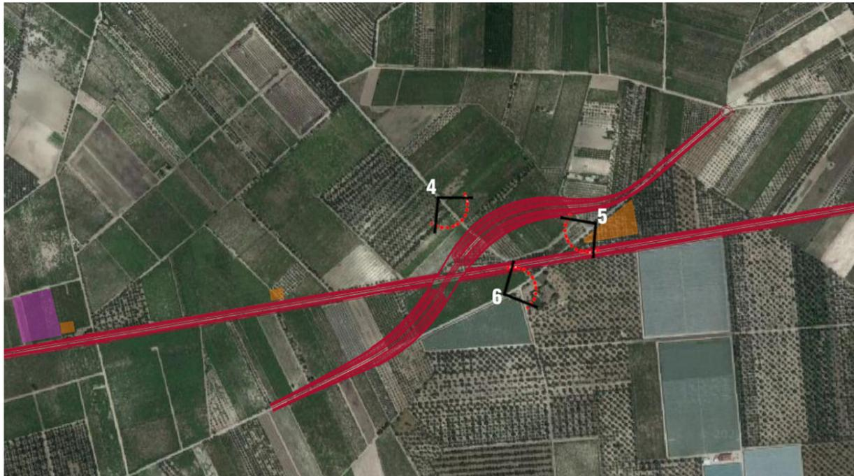
NV01 - INTERVENTO DI SCAVALCO FERROVIARIO PER LA SOSTITUZIONE DEL PASSAGGIO A LIVELLO
