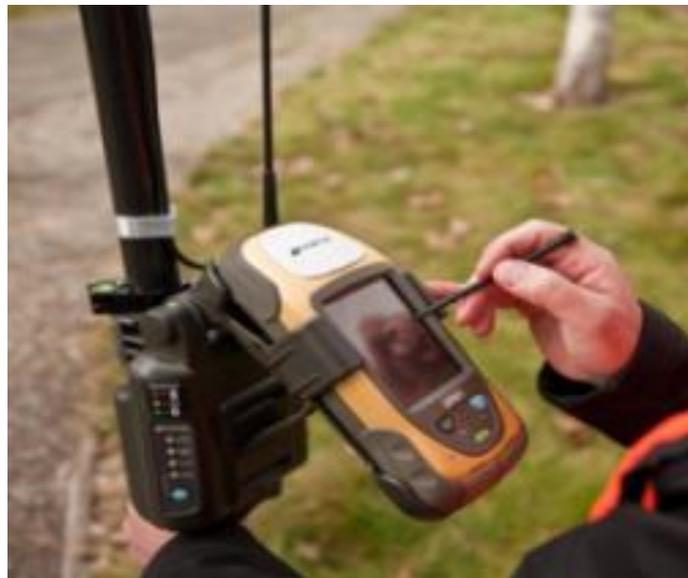
Figura4- Ricevitore RTK Topcon GRS-1.
