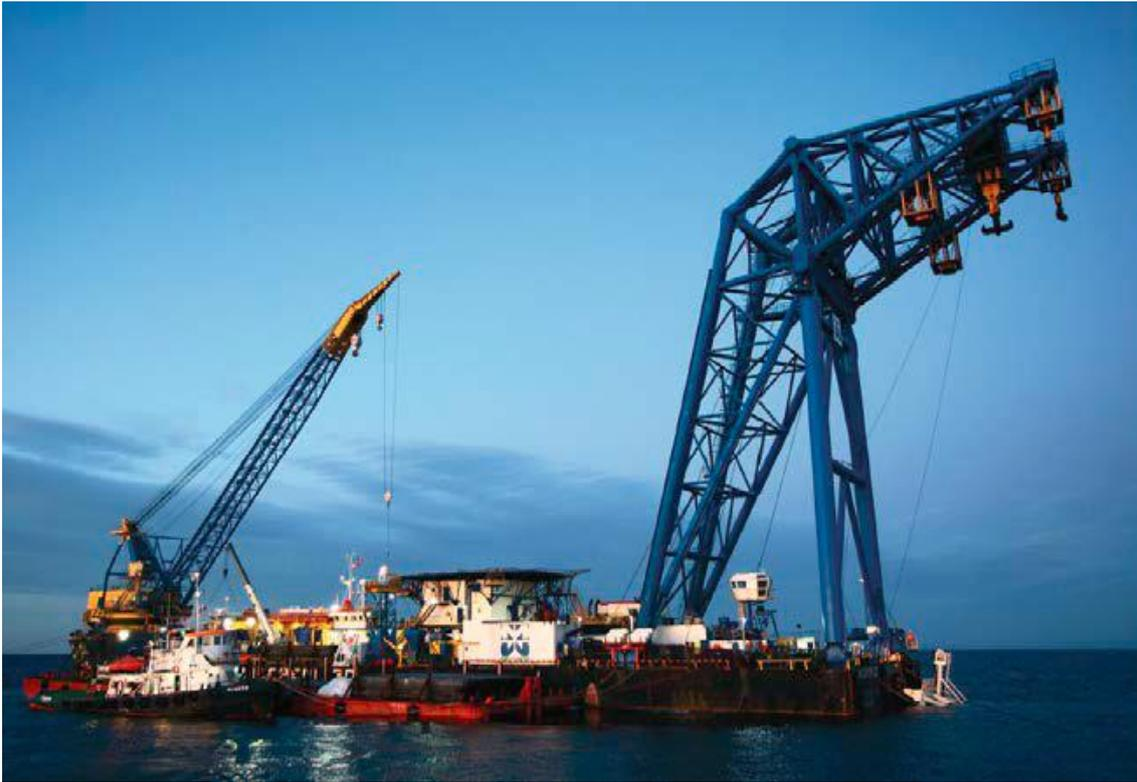
**Figura 3.2 – Tipica Nave Gru con Gru a Braccio Fisso e con Booming**
