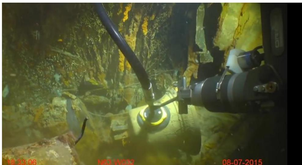
**Figura 3.18 – Utilizzo della ventosa per il recupero di un elemento di interesse storico da un relitto**
