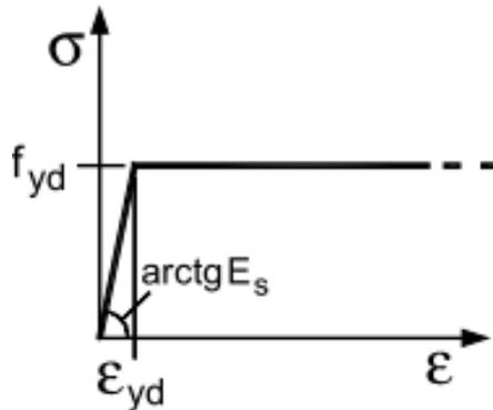
Fig\_2 Diagramma tensione-deformazione dell'acciaio
