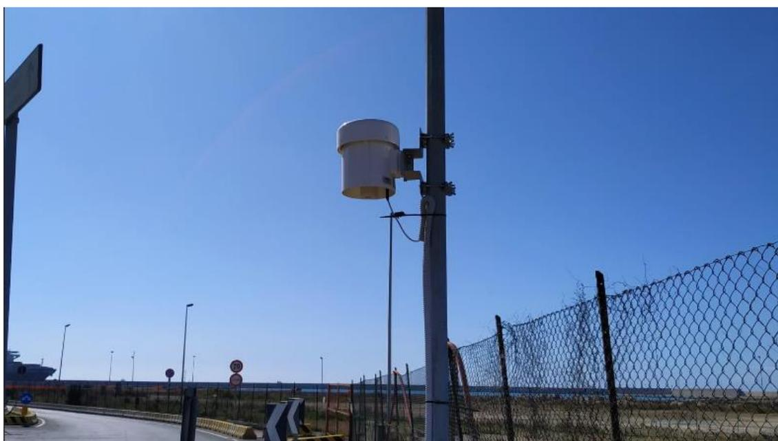
Figura 7: Campionatore a flusso 0.5 l/min (in alto) e a flusso 2 l/min (in basso) installati nella zona portuale di Civitavecchia.
