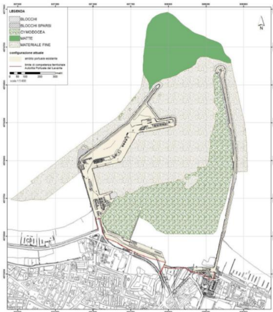
Caratteristiche dei fondali del porto di Barletta (rilievo morfologico 2009)
