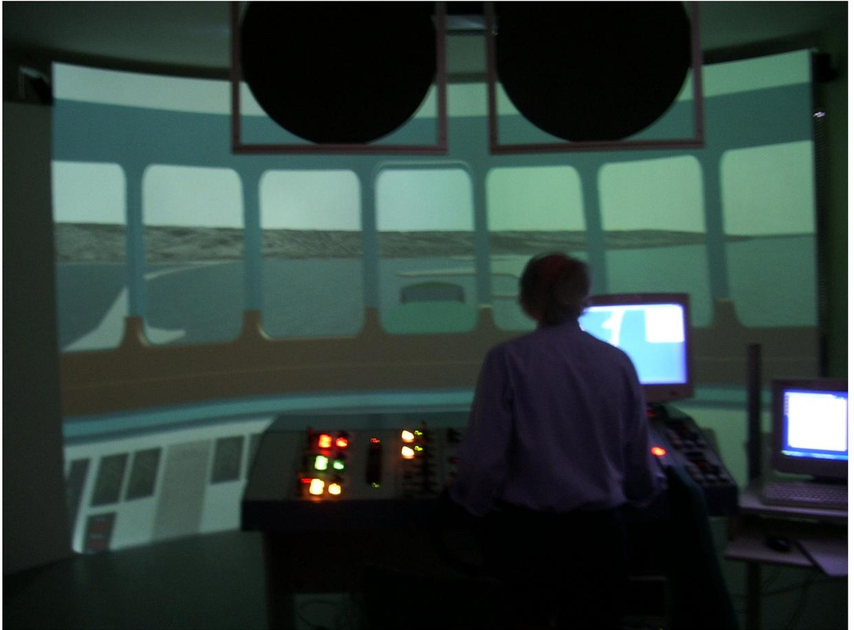
**Figura 1. Simulatore di manovra - Vista della plancia e della visualizzazione 3D**
