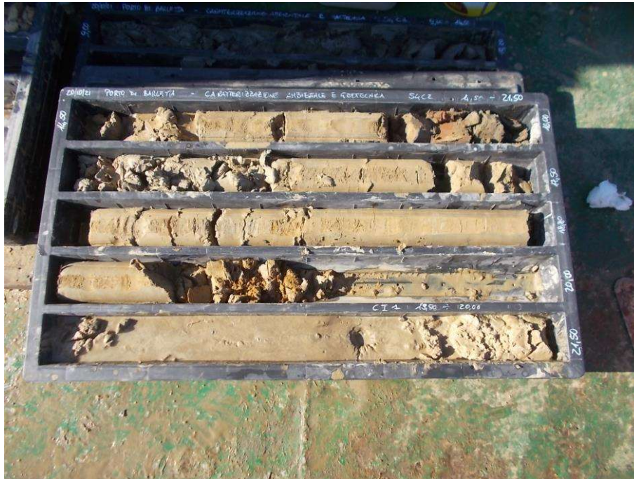
Foto 21: Sondaggio BT01-004 - Cassetta 2
