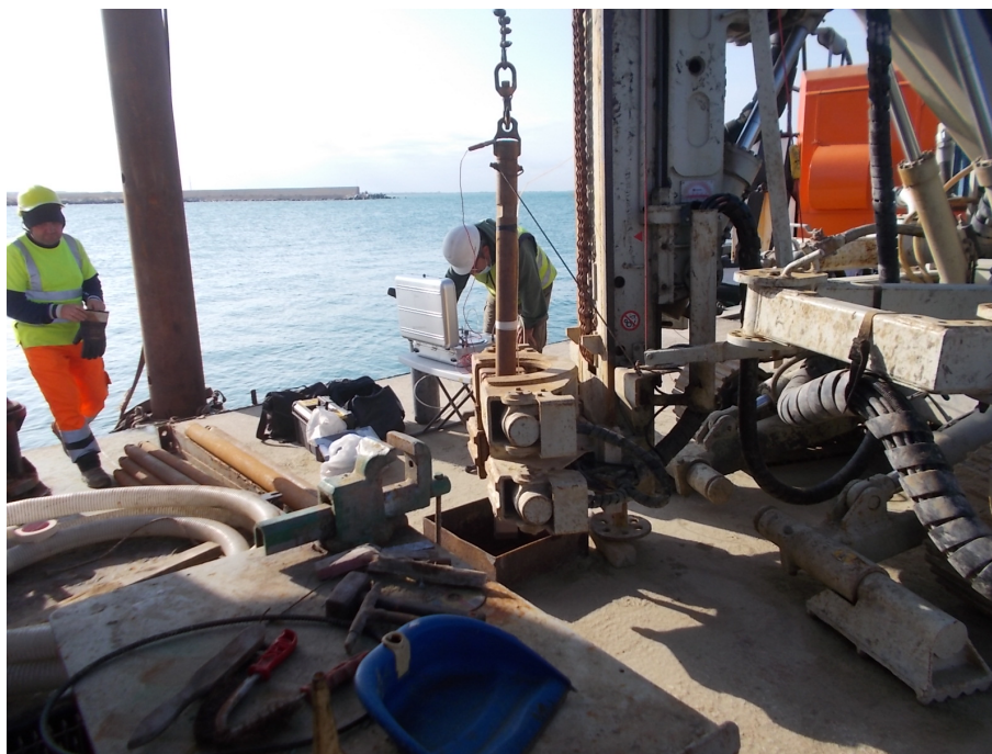
Foto 45: Postazione BT01-005 - Prova SDMT
