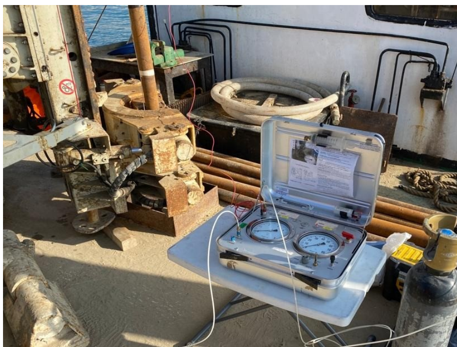
Foto 42: Postazione BT01-003 - Prova SDMT
