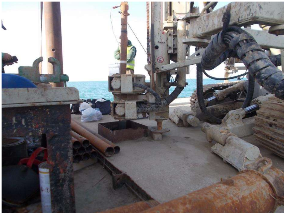
Foto 40: Postazione BT01-002 - Prova SDMT
