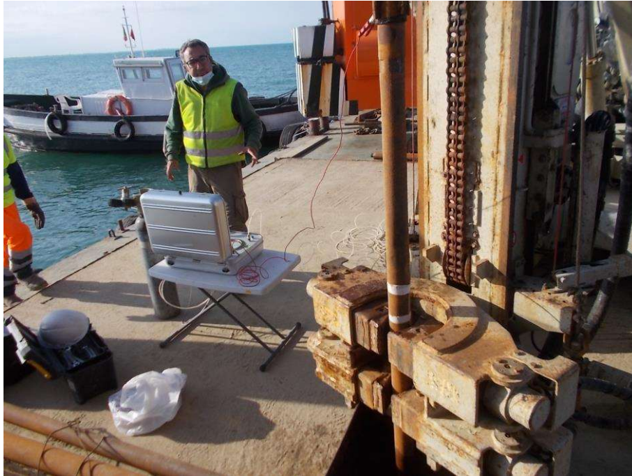
Foto 43: Postazione BT01-004 - Prova SDMT
