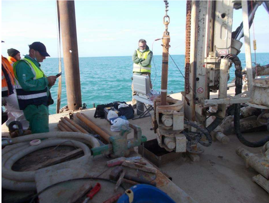
Foto 39: Postazione BT01-002 - Prova SDMT
