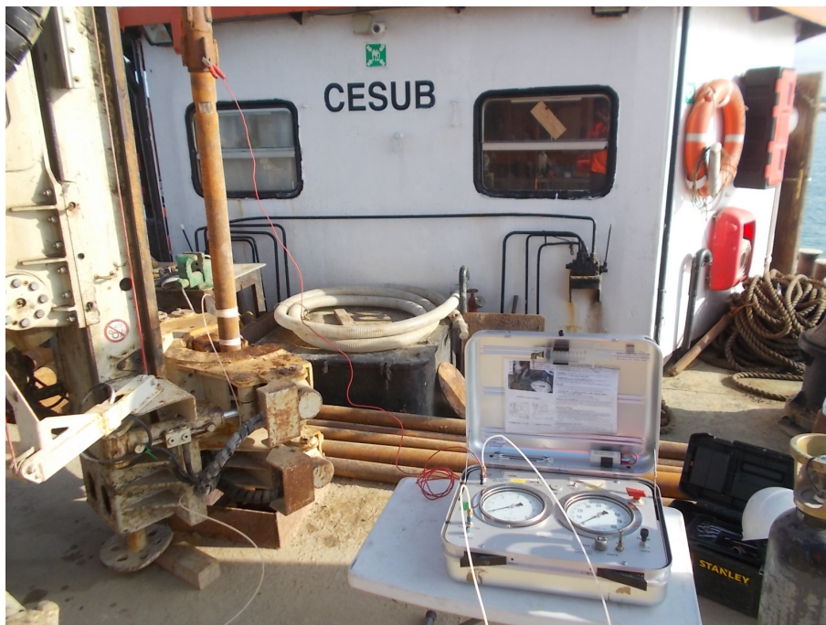
Foto 46: Postazione BT01-005 - Prova SDMT
