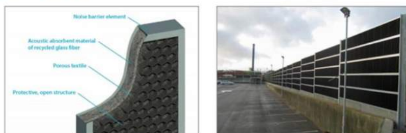
Figura 8 – Esempi delle potenzialità di recupero/riciclaggio delle pale degli aerogeneratori
