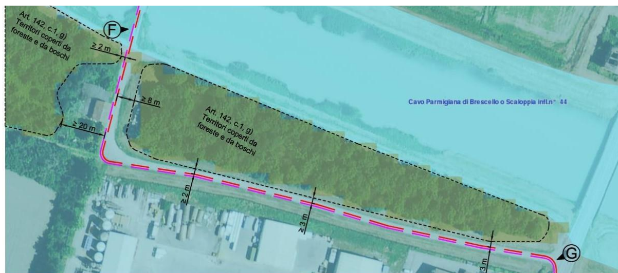
Figura -7 – Dettaglio distanze elettrodotto da area tutelata ai sensi dell'art. 142 c. 1, g) del D.Lgs. 42/2004 e s.m.i.,
