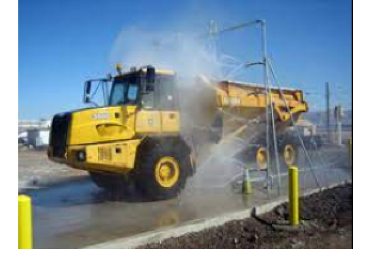
Foto 3: Soluzione lavaggio automatico con getto ad alta portata d'acqua per entrata/uscita dei mezzi di cantiere
