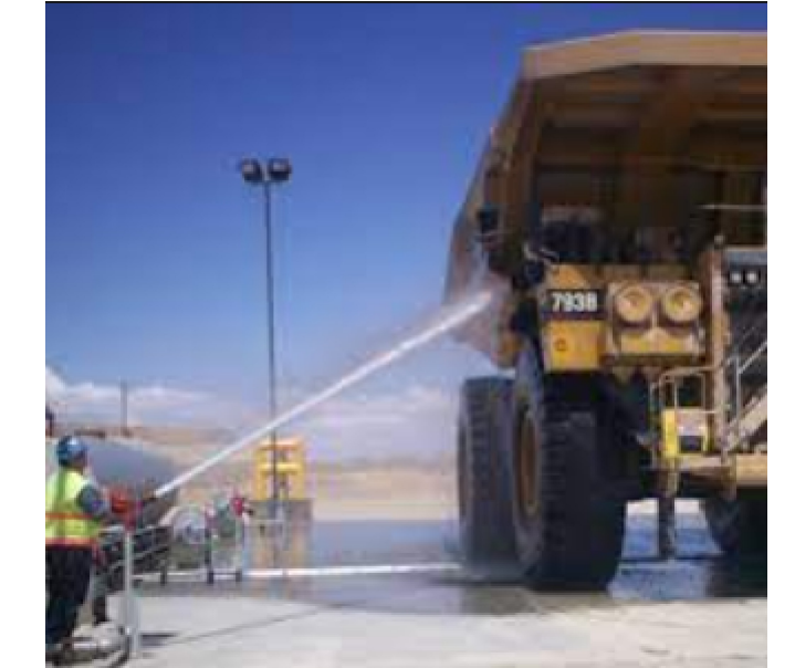
Foto 2: Soluzione lavaggio ruote automezzi attraverso tubo in gomma rigida con elevata portata d'acqua per rimuovere velocemente lo sporco dai veicoli movimento terra, materiali inerti etc...
