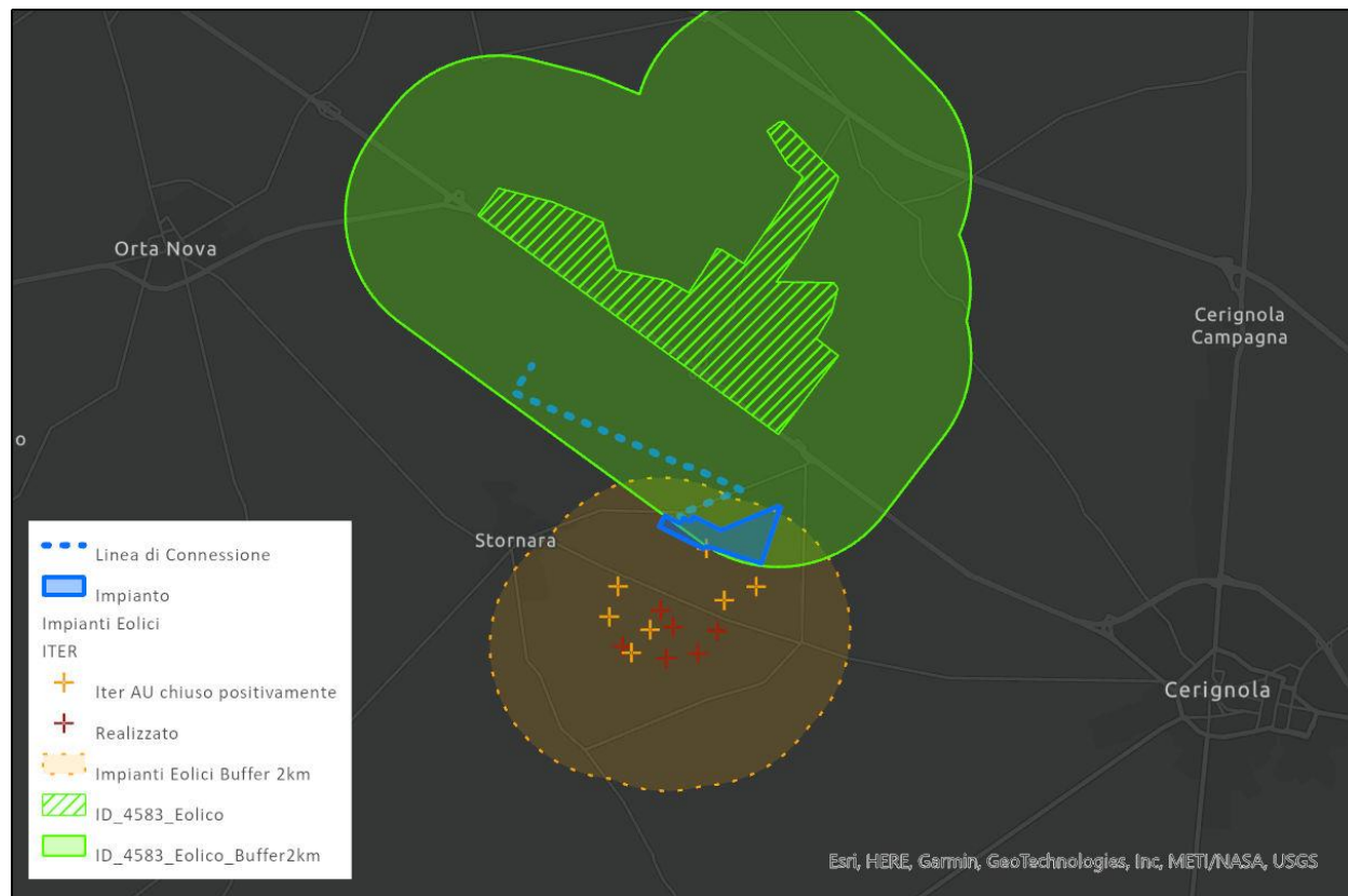
Figura 7.8: Verifica del Criterio B (Atto Dirigenziale n. 162 del 6 giugno 2014) rispetto all'impianto ID 4583, in fase istruttoria e pubblicato sul sito del MITE
