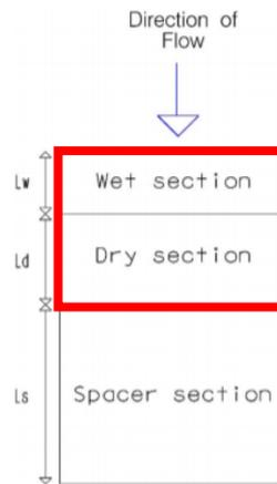
Figura 4.59: modulo tipo descrivente il modello concettuale idrologico dell'installazione di strutture fotovoltaiche a tracker su pari infissi comprendente l'area pannelli (in rosso) e l'area di interfila (Fonte: Hydrologic response of solar farm Cook 2013 American Society of Civil Engineers)
