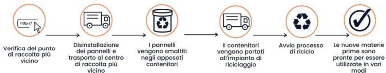
processo di riciclo pannelli fotovoltaici
