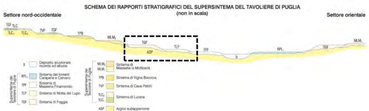
Figura 6-5: Schema rapporti stratigrafici – Fonte: ISPRA
