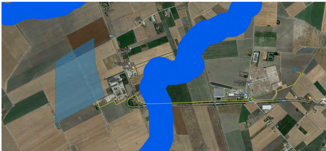
Figura 6-1: Interferenza progetto - struttura idro-geomorfologica PPTR, in blu il perimetro di impianto, in giallo il tracciato della connessione
