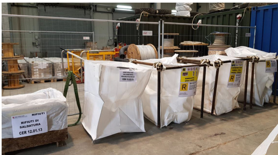
Fig. 7.10/C: Deposito temporaneo rifiuti pericolosi
