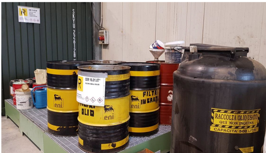
Fig. 7.10/B: Deposito temporaneo rifiuti liquidi pericolosi
