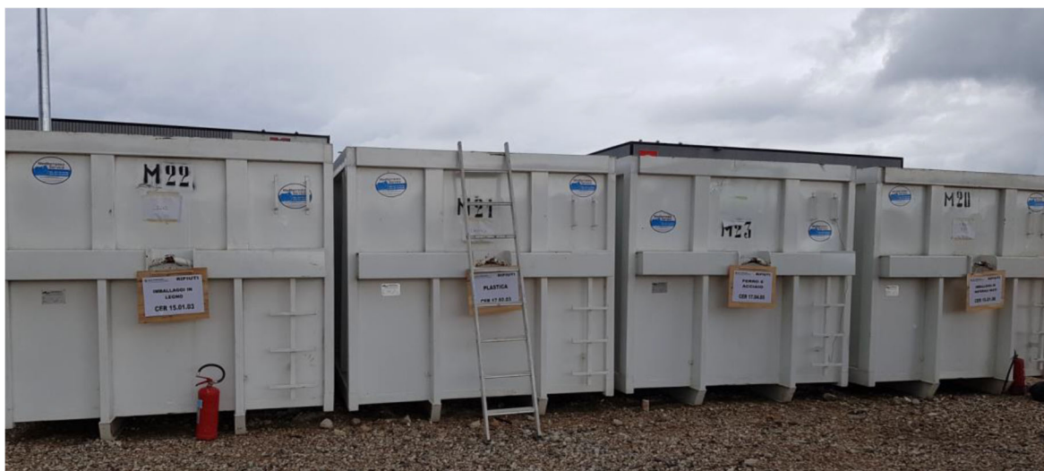
Fig.7.10/A Esempio deposito temporaneo rifiuti non pericolosi in container scarrabili
