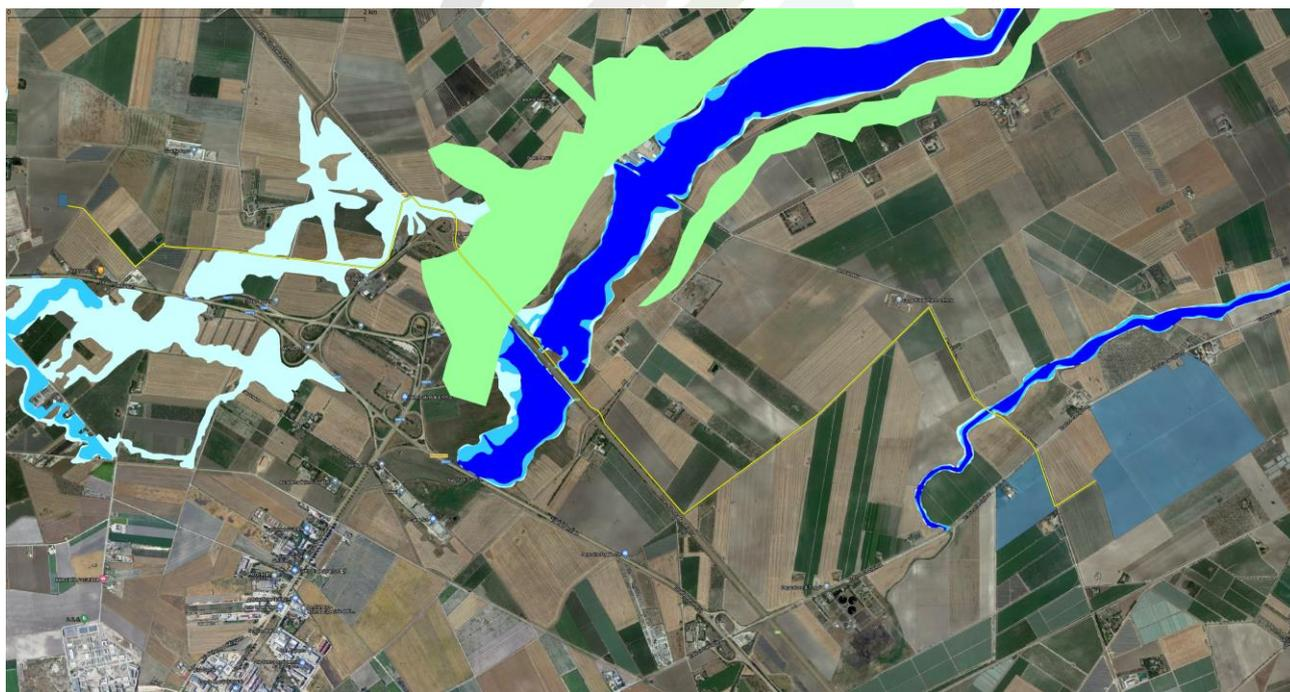
Figura 4-22: PAI – Pericolosità Frane e Inondazioni, in blu le aree oggetto di DDS, in giallo il tracciato dell'elettrodotto
