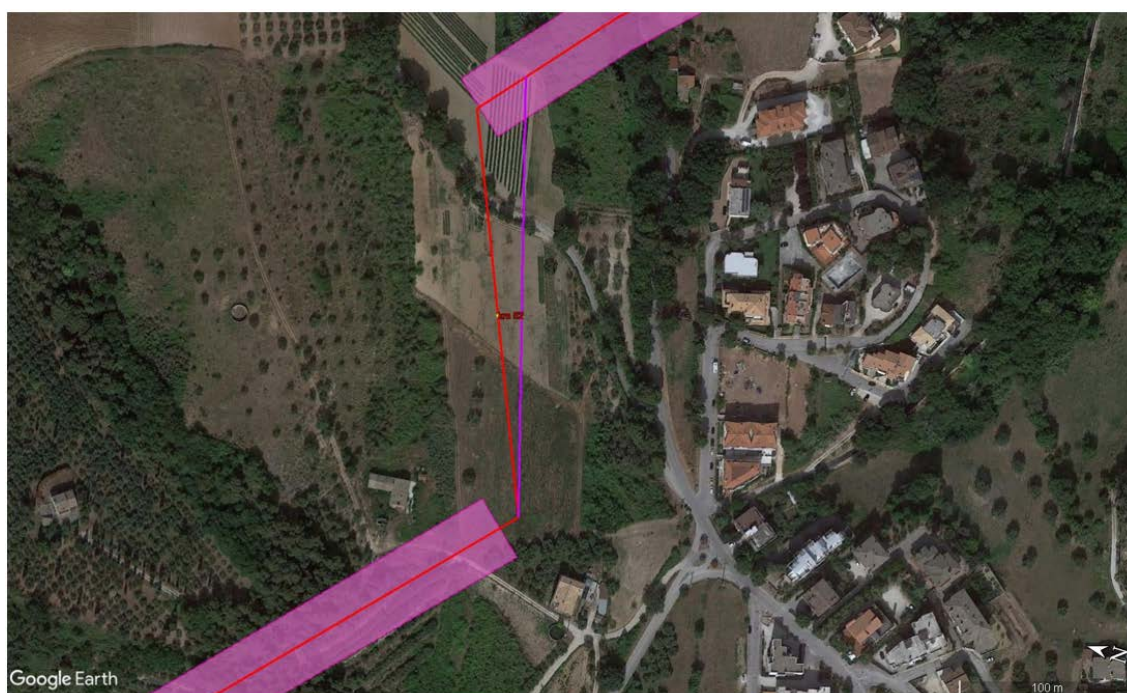
Figura 2.8/D - Ottimizzazione n.8. Tracciato originario (rosso) e ottimizzato (viola) su foto satellitare Google Earth. Le aree in viola rappresentano i tratti in trenchless.
