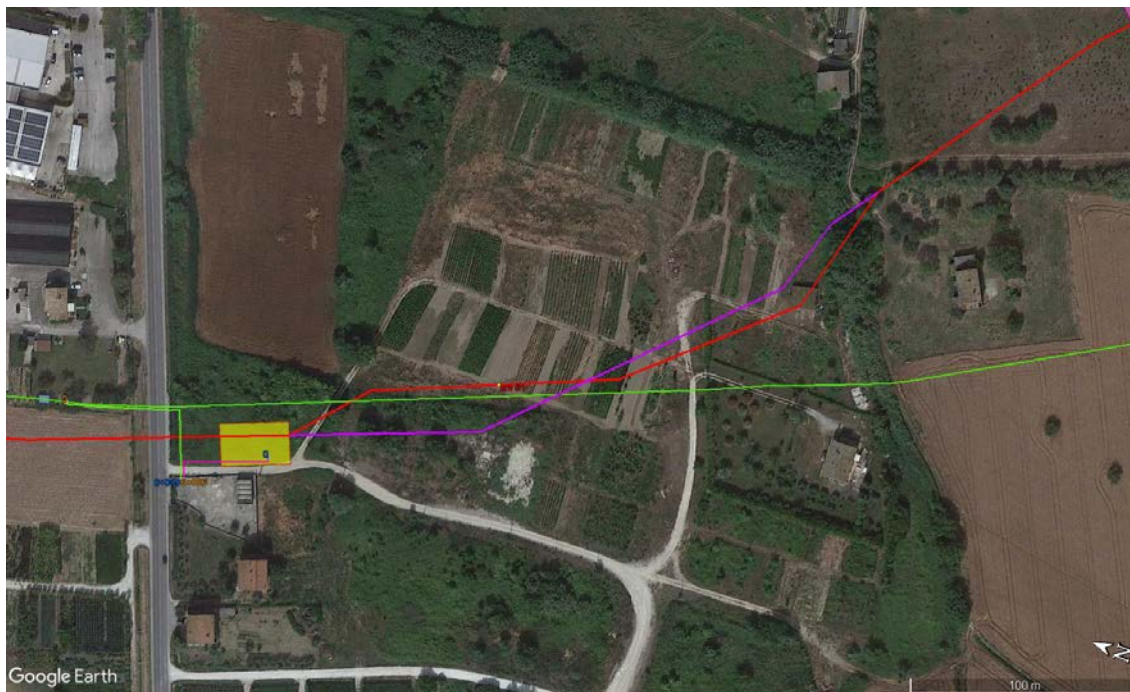
Figura 2.7/D - Ottimizzazione n.7. Tracciato originario (rosso), tracciato ottimizzato (viola) e condotta esistente da porre fuori esercizio (verde) su foto satellitare Google Earth.
