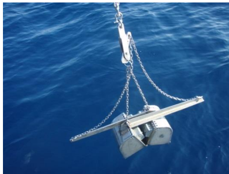
Fig. 2.5 – Benna Van Veen utilizzata per il prelievo di campioni di sedimento da destinare alle indagini ecotossicologiche.
