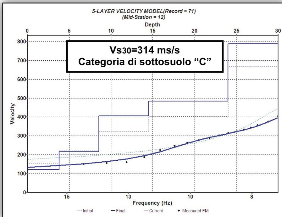
Modello di velocità (Vs) in funzione della profondità e della frequenza
