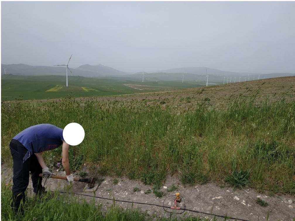
Energizzazione con mazza battente onde di superficie (Masw) e onde longitudinali (Onde P)
