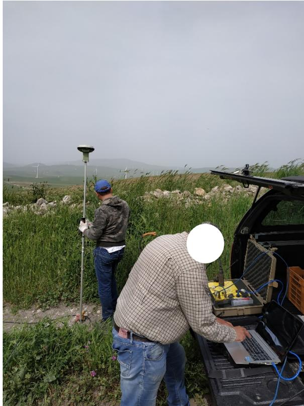
Acquisizione dati misure sismiche e georeferenziazione punti stazioni geofoniche
