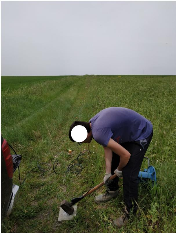
Energizzazione con mazza battente onde di superficie (Masw) e onde longitudinali (Onde P)
