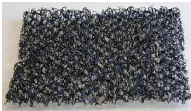
Fig. 18 - Esempio di struttura di geostuoia
