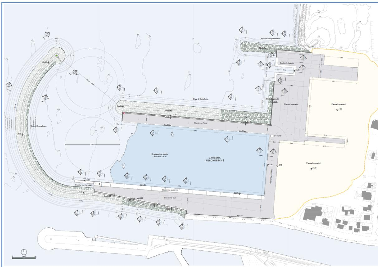
**Figura 2.** Darsena Pescherecci. Planimetria generale di intervento (rif. elaborato EG.OM.01)
