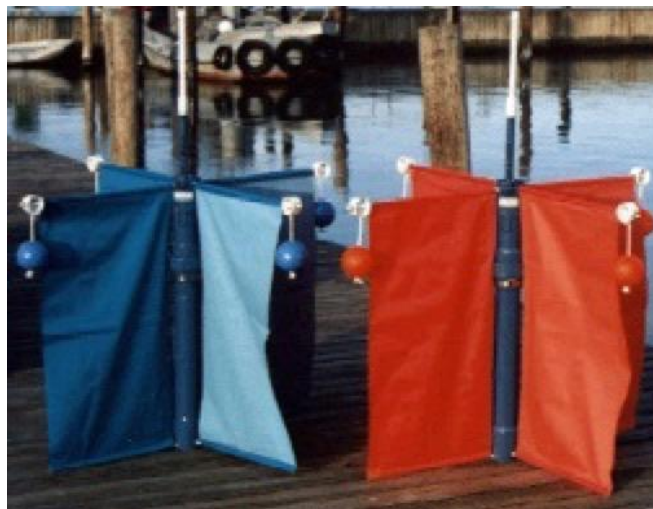
Figura 16. Drifter per lo studio delle correnti superficiali
