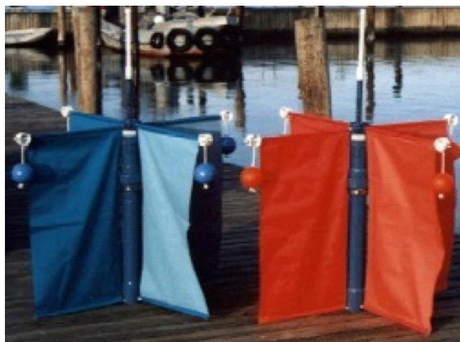
Figura 16. Drifter per lo studio delle correnti superficiali
