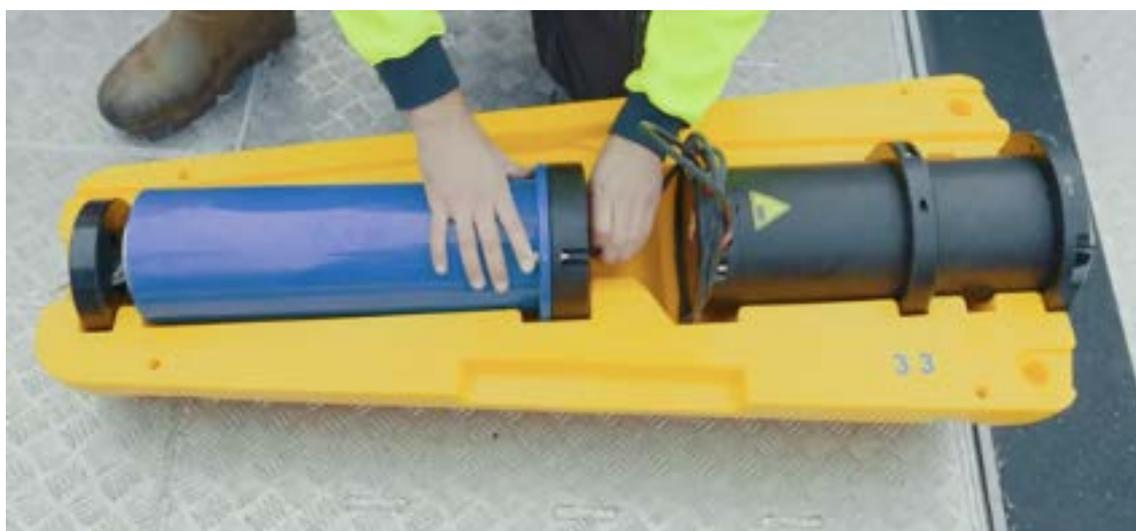
Figura 25 Boa di spinta per ADCP e pacco batteria
