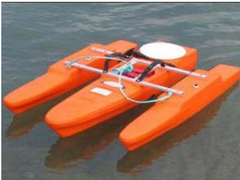
Figura 28 Esempio di acquisizione da imbarcazione dei dati di correnti con ADCP su struttura galleggiante
