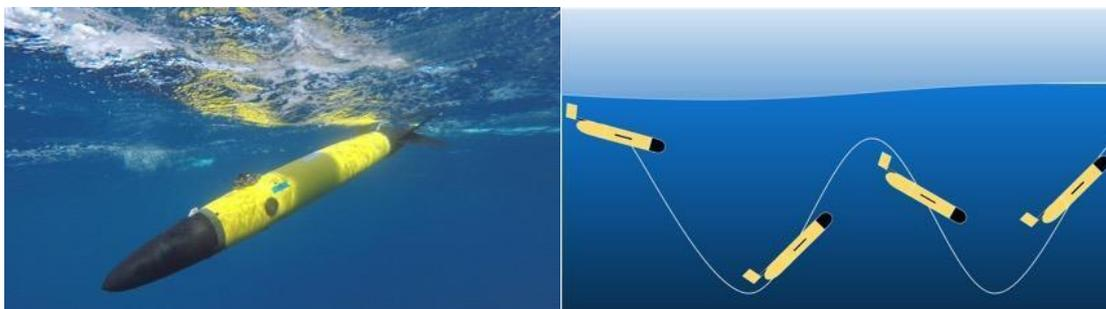
Figura 34 Piattaforma Glider tipo e simulazione delle traiettorie effettuate in colonna d'acqua
