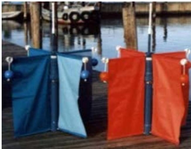
Figura 30 Esempio di Drifter per lo studio delle correnti superficiali
