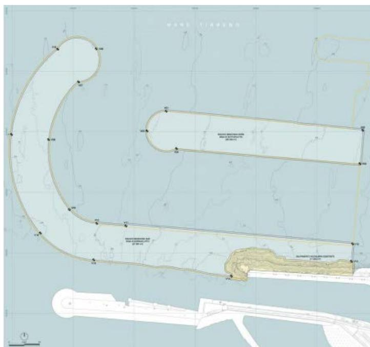
Figura 51 Il poligono più grande in trasparenza rappresenta Diga di Sopraflutto e la Banchina Sud mentre quello più piccolo in alto indica la Diga di Sottoflutto e la Banchina Nord. Tra le due banchine sarà realizzato l'approfondimento del fondale del bacino portuale alla quota di progetto – 6.00 m s.l.m.m.
