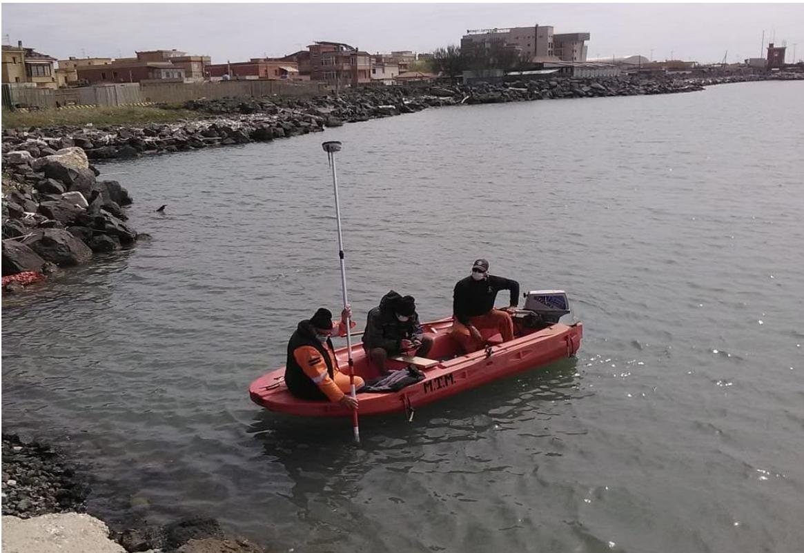
Figura 10 – Rilievo vasca di sedimentazione Area 1
