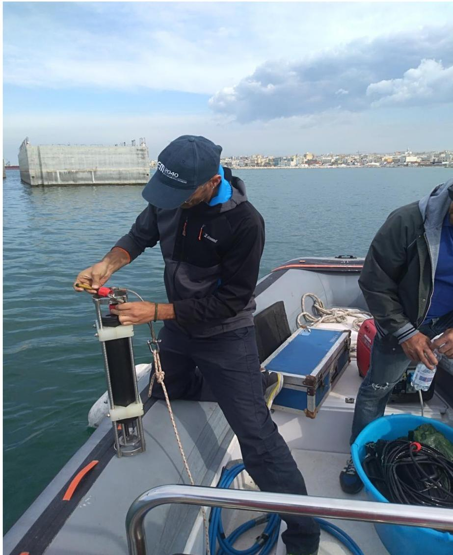
Figura 7 - Sonda di velocità SVP Monitor utilizzata (foto di repertorio).
