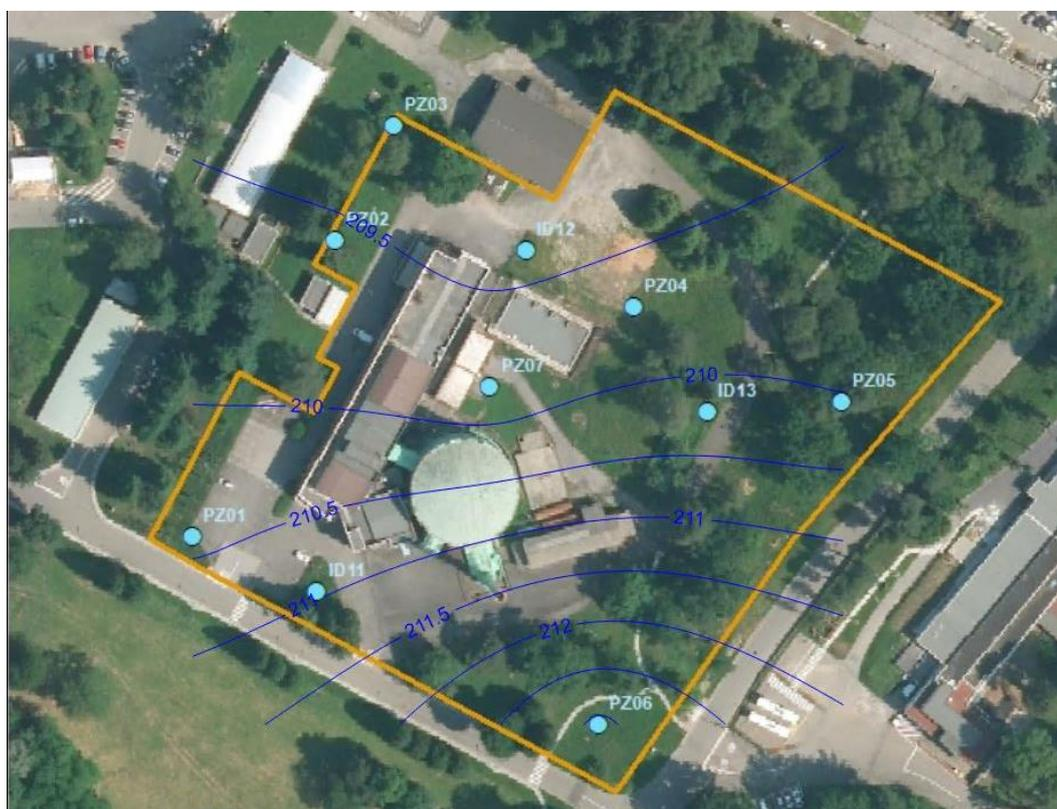
Figura 7–7 Andamento della superficie piezometrica in sito a giugno 2021
