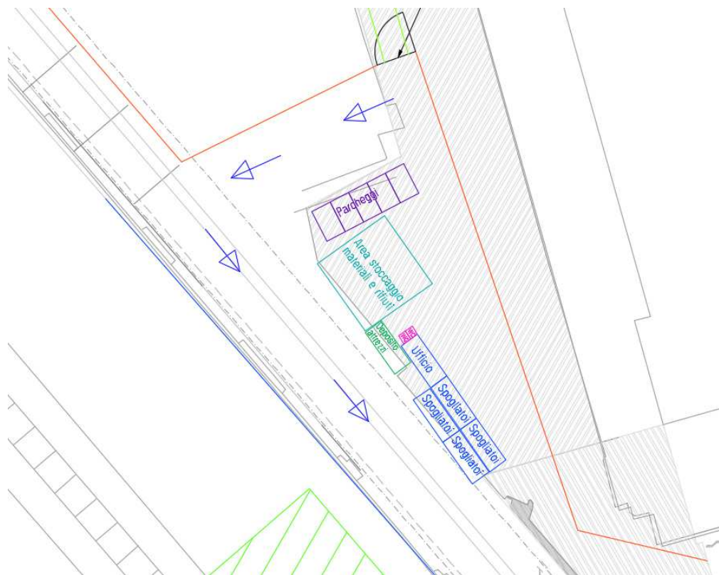
Figura 13 - Layout di cantiere: Particolare 1
