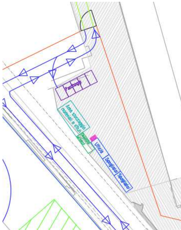
Figura 10 - Layout di cantiere: Particolare 1
